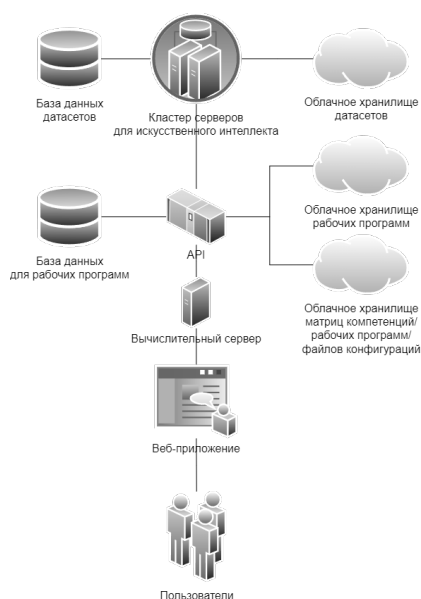
Рис. 1. аппаратная архитектура системы мониторинга
